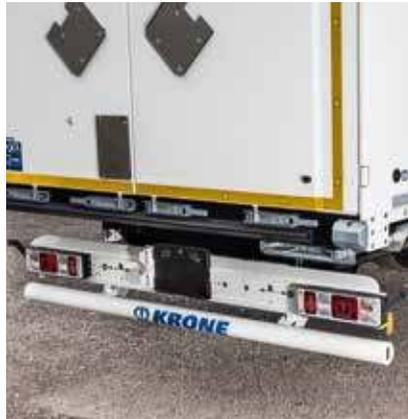
**Противоподкатный брус в виде трубы.**
