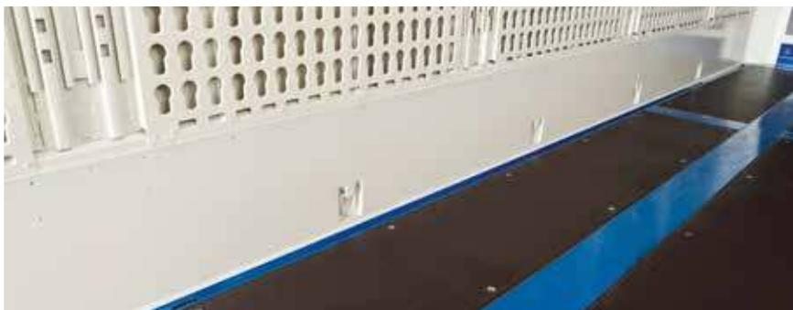
**Защитный пояс с встроенными крепежными кольцами.**
