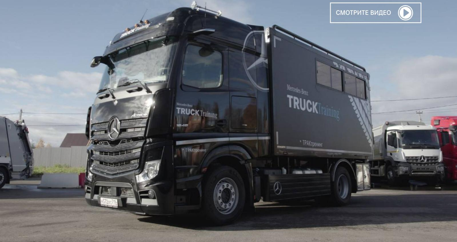
**Д**анная модель произведена на заводе Mercedes-Benz в Вёрте, а кабина нового Actros 1848 L доработана до семиместной на мануфактуре Mercedes-Benz «СТТ» в Мольсхайме. Уже в России на шасси установили единственную в своем роде надстройку – многофункциональный фургон, который стал передвижным учебным классом со всеми атрибутами. Новый учебный грузовик забалластирован для имитации нагрузки, что совершенно необходимо для практического этапа тренинга в режиме реальных условий эксплуатации.
